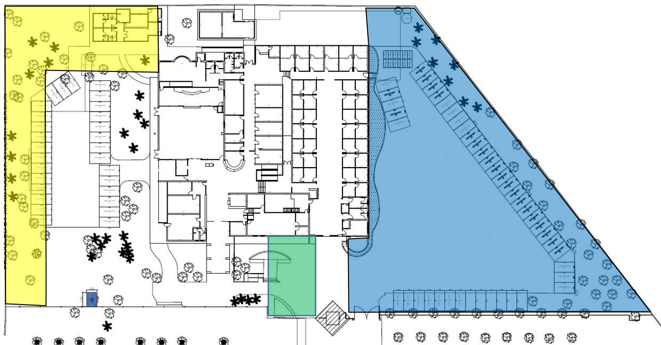
Figura 5. Possíveis diretrizes identificando as áreas de circulação de veículos e estacionamento: Veículos dos Vereadores e Oficiais (amarelo); Estacionamento dos Servidores (azul); Carga e Descarga (verde).
